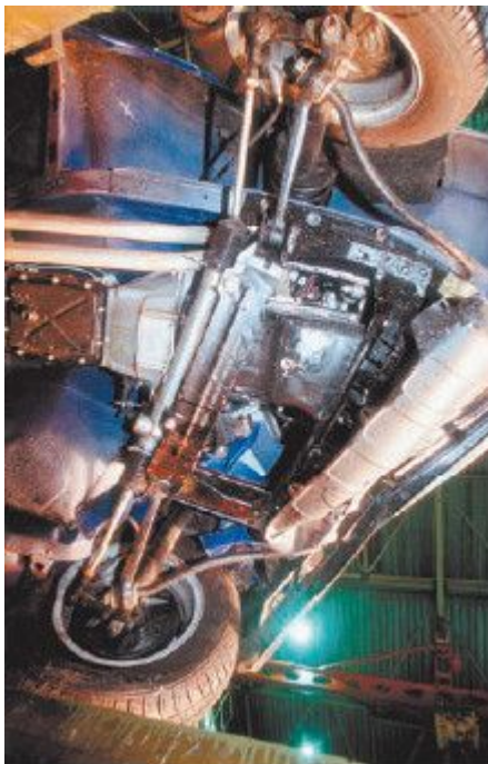
Рис. 5.9. Передняя подвеска: вид снизу
