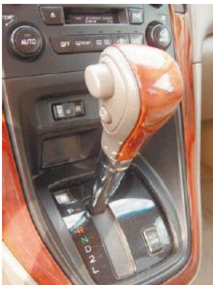
Рис. 4.6. Рычаг автоматической коробки передач (рычаг селектора)
