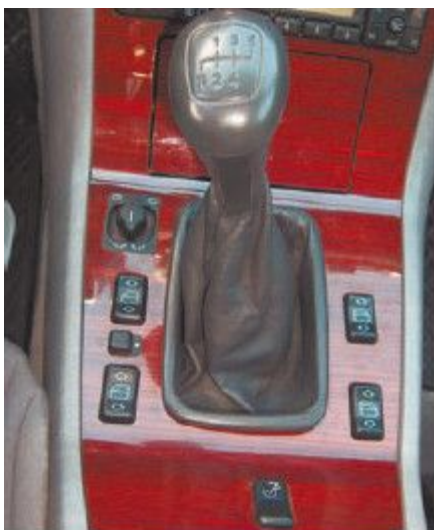
Рис. 4.5. Рычаг механической коробки передач
