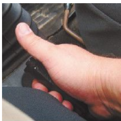
Рис. 6.2. Кнопка на рычаге стояночного тормоза
