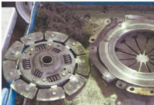
Рис. 4.3. Изношенные диск и корзина сцепления
